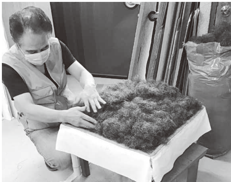
椅子張り作業中の小林さん（馬毛を使用しクッションを調整）
